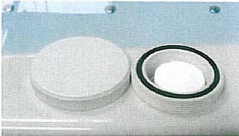
Bei der Frischwasser Reinigungsanlage wird Frischwasser ( Anschluss ½“ Kaltwasser ) über ein Magnetventil durch den Tablettenbehälter ( Vorher Aktiv-Sauerstoff Tablette einlegen ) in die Leitungen des Wassersystems geleitet. Dabei wird das Leitungssystem gespült und gereinigt.
